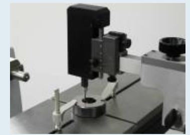
Prüfen von kleinen Lehringen ab 2 mm Ø als Standard
