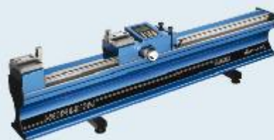
ALESTA Absoluter Messbereich : 0 -300/500mm Fehlergrenzen : 1,5 + L (mm)/300
