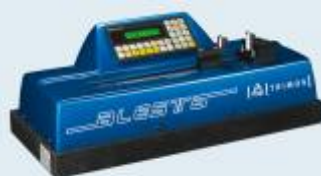
ALESTA Absoluter Messbereich : 0 -300/500mm Fehlergrenzen : 1,5 + L (mm)/300
