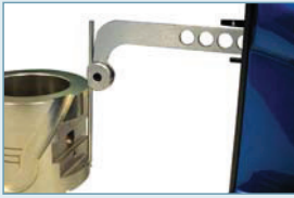
Orientabler Spezialtaster mit Messeinsatz Checking with special orientable accessory
