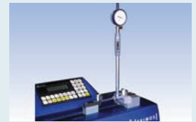
Einstellen eines 2-Punkt-Bohrungsmessgerätes mit Analog-Messuhr Setting of two-point bore gauges analog
