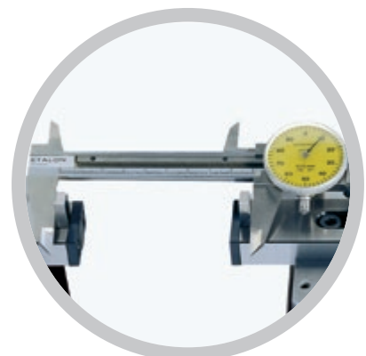
Prüfen / Kalibrieren von Messschiebern
