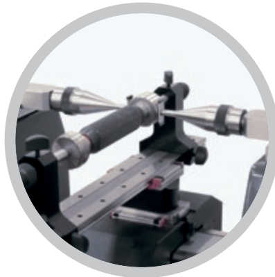
Prüfen / Kalibrieren von Gewindelehrdornen
