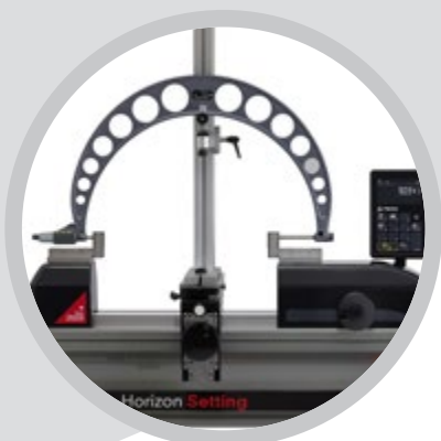
Prüfen / Kalibrieren großer Bügelmessschrauben
