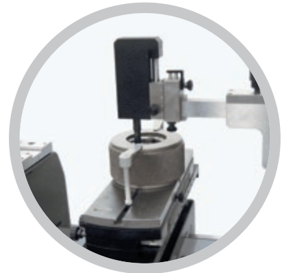
Prüfen / Kalibrieren von Gewindelehrringen
