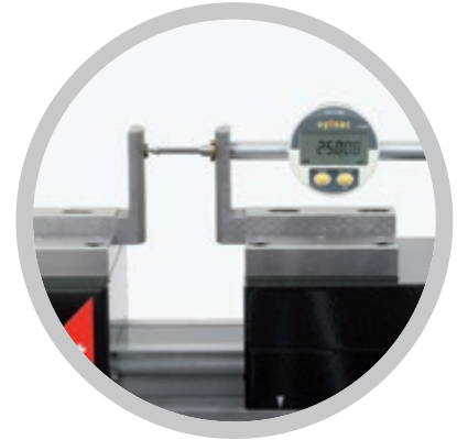
Prüfen / Kalibrieren von Messuhren
