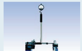
Einrichten von 2-Punkt-Bohrungsmessgeräten Setting of 2-point bore gauges
