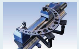
Prüfen großer Bügelmessschrauben Large micrometers control
