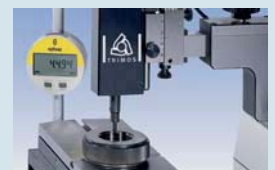
Prüfen von Gewinde-Lehrriegen Checking of thread ring gauges
