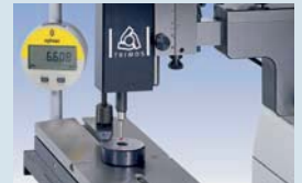
Prüfen von Lehrriegen Checking of ring gauges
