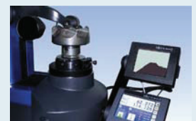
Messen von Messerköpfen Checking of a face cutter
