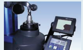
Messen von Schaffräsern Checking of a thread cutter
