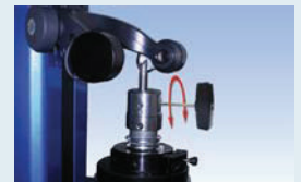
Einstellen und Messen von Werkzeugen Checking of a fine bohr
