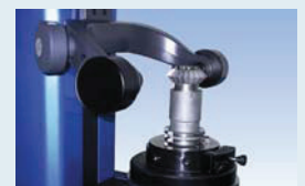
Messen von Formwerkzeugen Checking of a chamfer cutter
