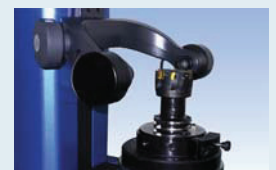
Messen von Messerköpfen Checking of a corner cutter
