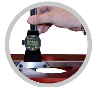
MESSUNG EINER HÖHE MIT MESSBRÜCKE
