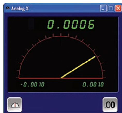
Analog oder Bargraph Anzeige der X-Achse
