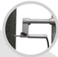
RECHTWINKLIGKEITSMESSUNG MIT ELEKTRONISCHEM TASTER (OPTIONAL FÜR V6)
