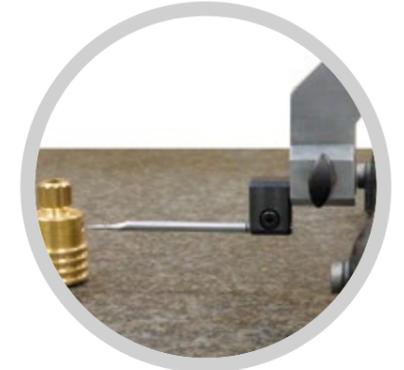
Messungen kleiner Durchmesser mit Messkugel  $\varnothing$  1 mm
