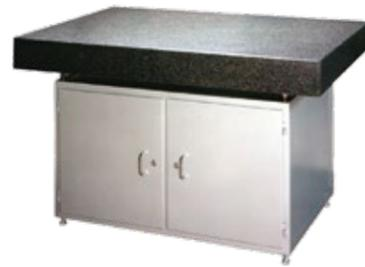
Aus dunklem Naturhartgestein, frei von jeglichen Fehlern, gefertigt in klimatisierten Räumen. Die Präzisions-Messflächen werden in einem Spezialverfahren nach DIN 876 fein diamantgeläppt. Die Genauigkeiten liegen teilweise mehr als 50 % über der DIN Norm. Zu jeder Messplatte wird ein Prüfprotokoll erstellt.
