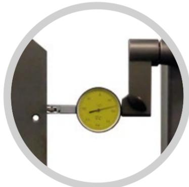
Mechanisch eingestellte Rechtwinkligkeit an allen Messgeräten
