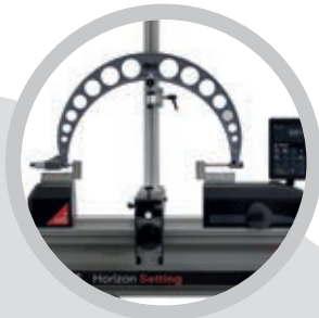
EINSTELLEN UND PRÜFEN VON BÜGELMESSSCHRAUBEN
