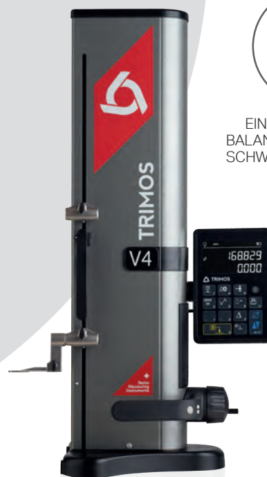
HANDKURBEL MIT FEINVERSTELLUNG V4 RF
