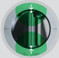
V9: SMART REVERSE DURCHMESSERMESSUNG MIT AKUSTISCHEM UND VISUELLEM SIGNAL
