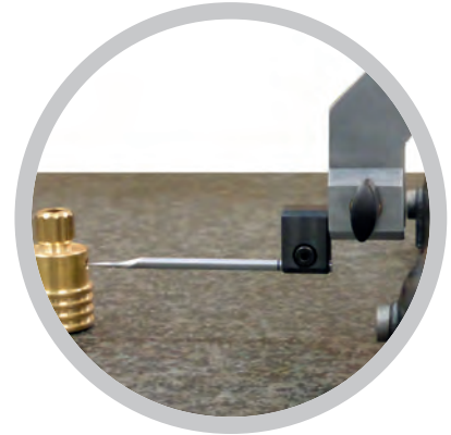
Messungen kleiner Durchmesser mit Messkugel Ø 1 mm
