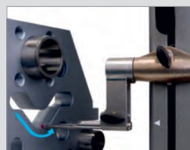
Konstante Messkraft im motorisierten Betrieb garantiert
