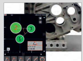
Zweikoordinatenmessung mit einfachem, grafischen Interface
