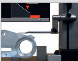
Grafische Hilfe bei der Winkel und Konusmessung
