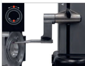
Durchmessermessung mit grafischer Hilfe
