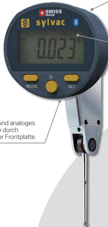
Digitales und analoges Nullstellen durch Drehen der Frontplatte
