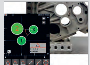
Zweikoordinatenmessung mit einfachem, grafischen Interface
