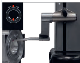
Durchmessermessung mit grafischer Hilfe
